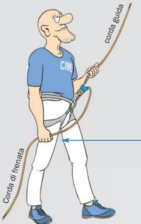
**Una caduta è possibile in ogni momento** e può essere trattenuta solo se il dispositivo d'assicurazione è manipolato correttamente. Ciò implica che la mano frenante avvolge sempre la corda di frenata (principio della mano frenante). La mano guida (chiamata anche mano sensore) ha la funzione di sistema d'allerta. Non appena la mano guida avverte uno strattone, l'assicuratore, di riflesso, stringe con la mano frenante la corda di frenata.
