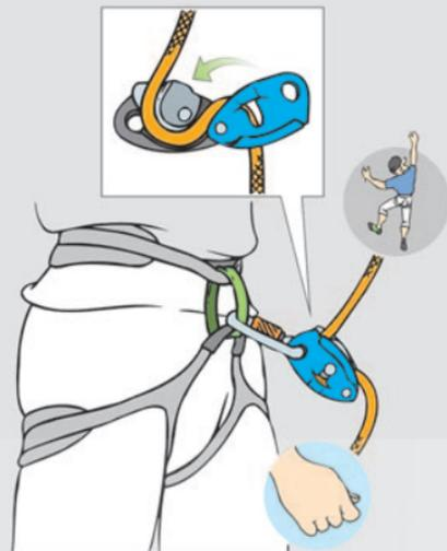
Posizione di partenza dispositivo semi-automatico
